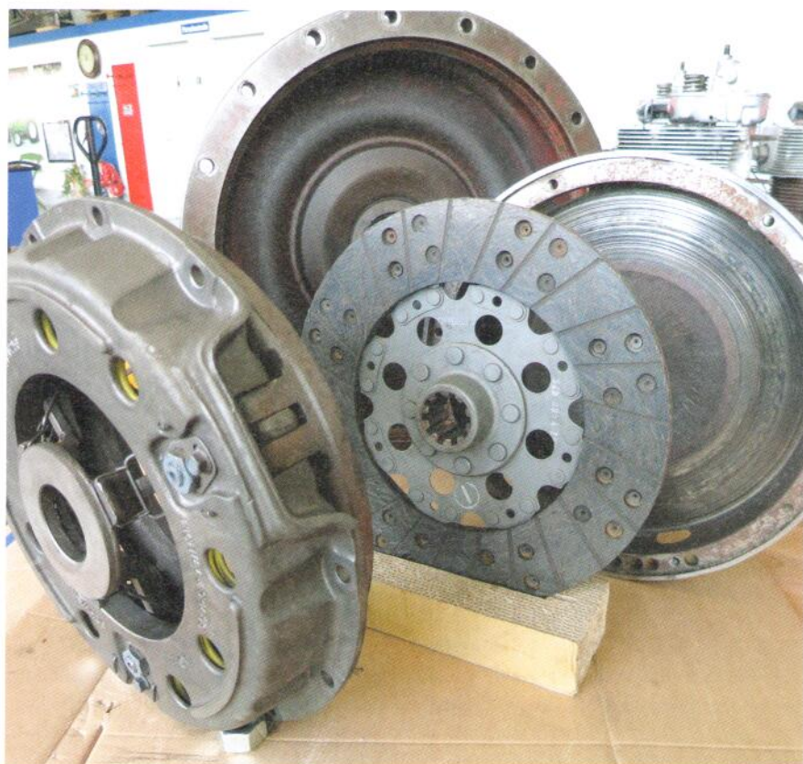
Die mechanische Kupplung.
